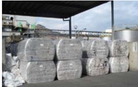
セメント用燃料（廃プラスチック・廃油）
